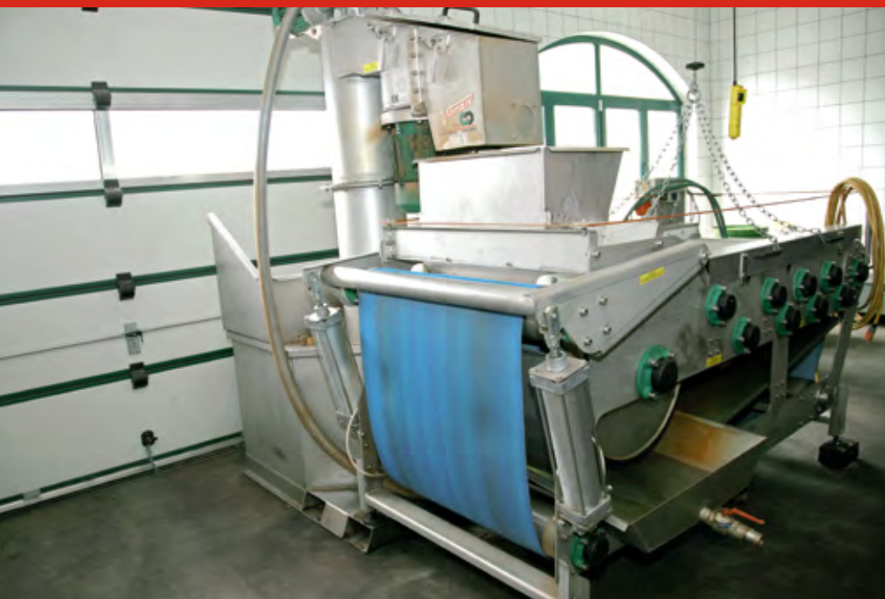
Fot. 2. Do tłoczenia soku używana jest prasa taśmowa
