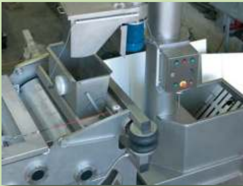
Bardzo dobrze dobrane parametry lejka-napełniacza z kontrolą stanu napełniania
