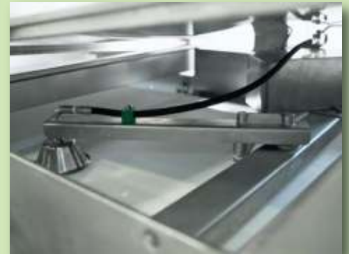
Element czyszczący taśmę pod wysokim ciśnieniem
