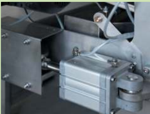
Pneumatyczna regulacja tarcy
